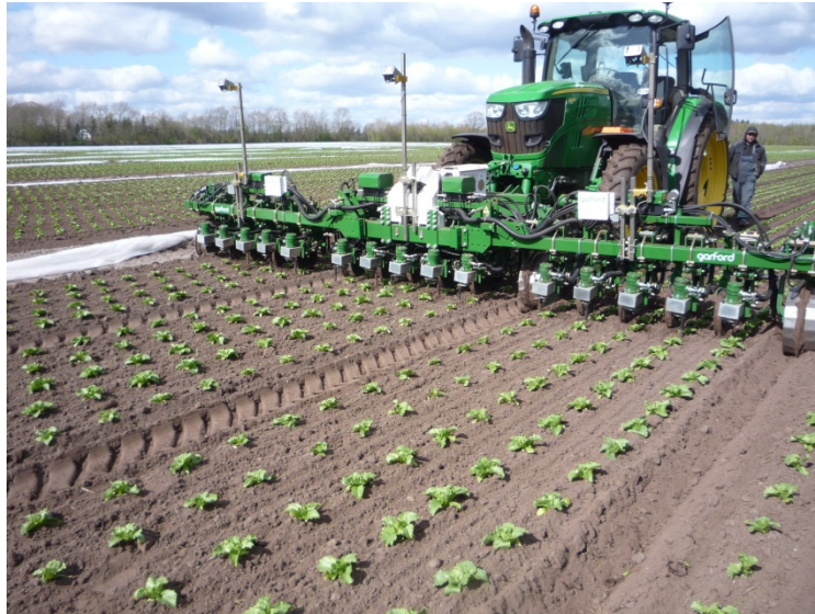
15-rækket Garford Robocrop InRow ukrudtsrobot. Foto: Pernille Kynde.
