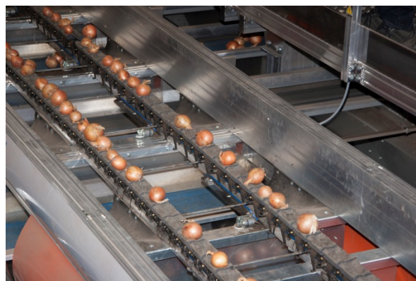
Båndet i den optiske sorterer, hvor de enkelte løg vippes af ved netop det sted, hvor de hører til afhængig af, hvordan indstillingen af anlægget er justeret. Kan sortere ud i mere end 10 forskellige kvaliteter. Foto: Stig F. Nielsen.
