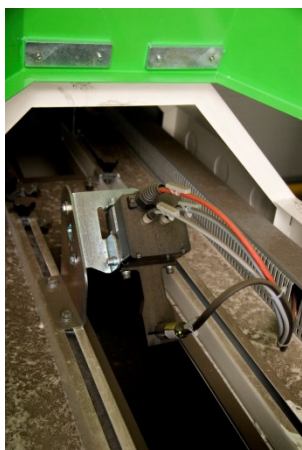
Kameraer i optisk sorterer, som både kan finde løg med ydre og indre fejl, sortere efter størrelser, farve og vægt. Foto: Stig F. Nielsen.
