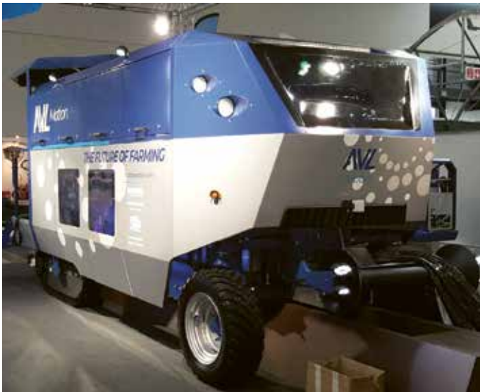
Høstmaskine til hvide asparges fra det hollandske firma AVL Motion. Video af maskinen i drift kan ses på YouTube.
