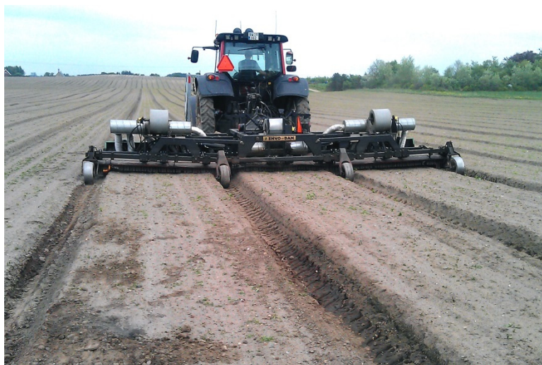
I stedet for brug af svindningsmiddel lige før fremspiring, kan man brænde ukrudtet med en gasbrænder. Foto: Lars Møller.
