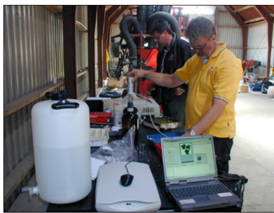
Figur 10. Ved brug af et Spectro-Fluorimeter blev koncentrationen af sporstof på de indsamlede blade bestemt.
