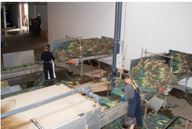
Porrevaskeri: Ilægning af porrer på bånd til vasketunnel, hvor rødder og top trimmes og porrer vaskes. Foto: Stig F. Nielsen.
